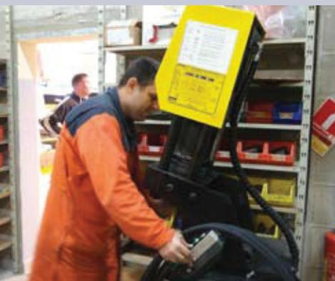
Defranoux propose dans ses deux agences un service de sertissage des flexibles, une opération qui peut aussi être réalisée dans une camionnette spécialement aménagée.
